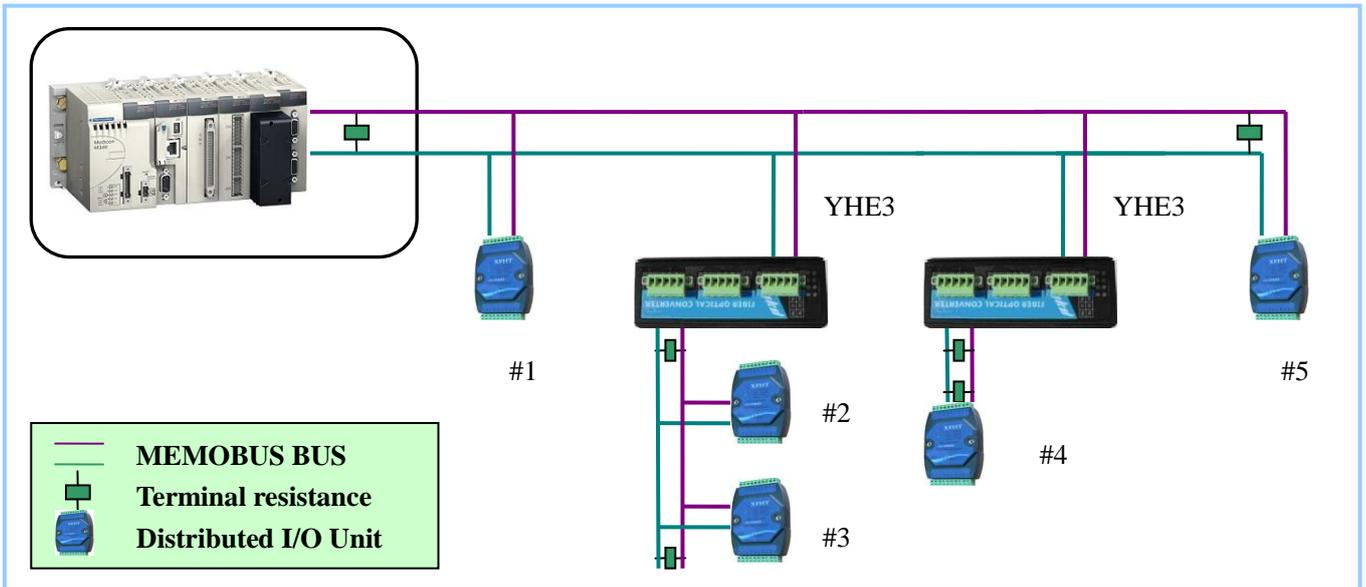
应用场合：多个总线节点间需要延长通讯距离，或者多个节点间需要完全的电气隔离抗干扰
